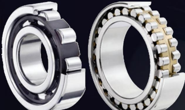
این نوع برینگ ها ضمن تحمل بارهای سنگین، قادر به چرخش با سرعتهای بالا نیز هستند. در یک نوع از آنها که شماره آن با حرف NU آغاز می شود، حلقه پایینی بدون لبه و قابل تفکیک شدن است و در نوع دیگر که با حرف N مشخص می شود حلقه بالایی بدون لبه است. در نوع دیگر که با NJ شروع می شود، حلقه داخلی در یک سمت دارای لبه است، لذا امکان تغییر مکان محوری از یک سمت وجود دارد.
