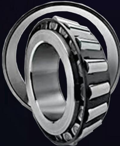
این برینگ ها دارای شیار غلتک مخروطی در حلقه بالایی و پایینی بوده و جزء غلتشی نیز در آنها به شکل مخروطی می باشند. این نوع طراحی، برینگ را برای تحمل بارهای مرکب (شعاعی و محوری) مناسب ساخته است. رولبرینگ های مخروطی در انواع مختلف یک ردیفه، دوردیفه و چهار ردیفه در دو اندازه متریک و اینچی تولید می شوند. یک نوع از این برینگها به TQ معروف است که کاهش اصطکاک و افزایش قدرت تحمل بار از خصوصیات آن می باشد.
